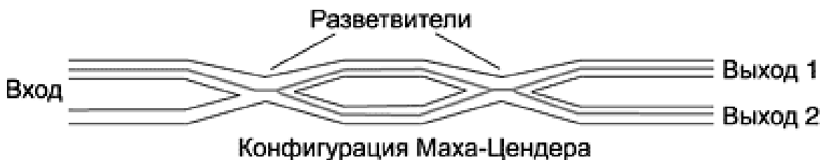
Рис. 1.3.6 Входной сигнал распределяется между двумя выходами
