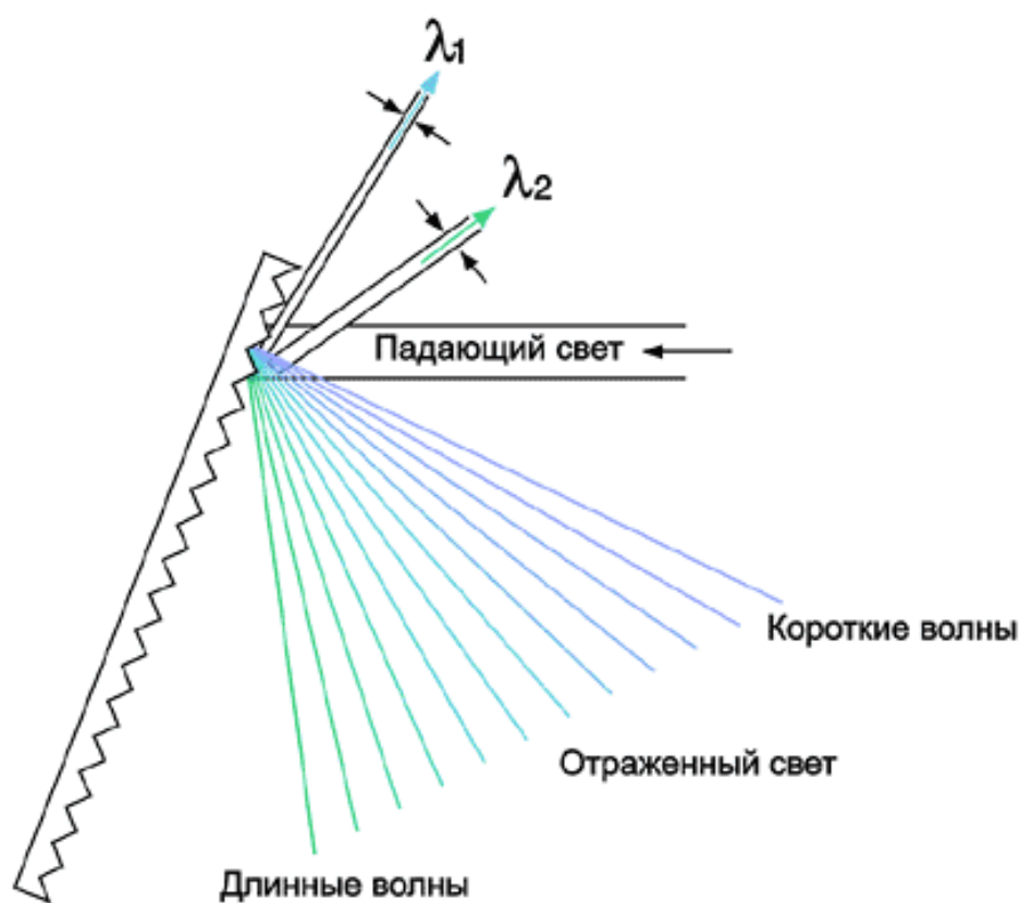
Рис. 1.3.5 Отражение составного сигнала дифракционной решеткой
