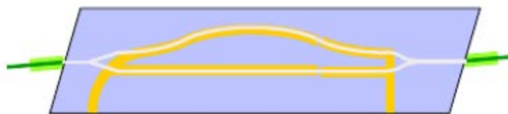
Рис. 4.1.10. Модулятор IMZI с высокой разностью хода между двумя плечами
